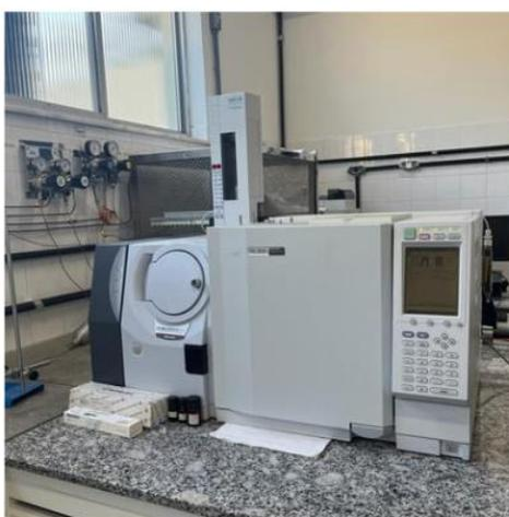
**Figura 7** – Cromatógrafo gasoso acoplado a espectrômetro de massas (CG-EM)
